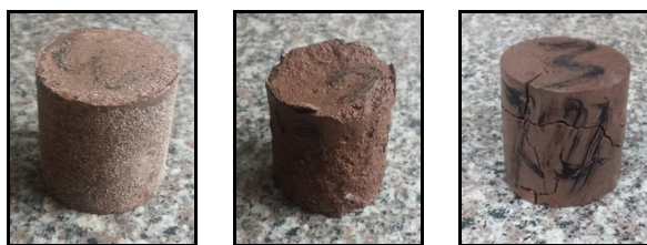
(a) 3% K_2CO_3 , 未浸水 (b) 3% K_2CO_3 , 浸水 (c) 3% NH_4H_2PO_4 , 浸水
